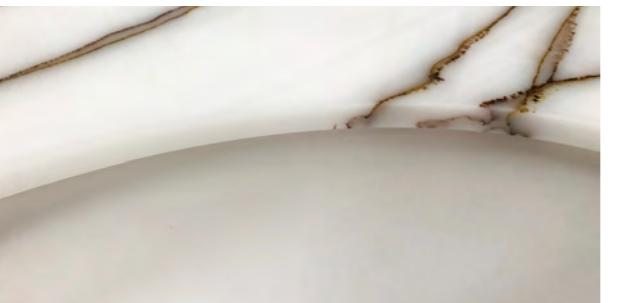
Coverlux™ es un material que se presenta en forma de plancha, y está compuesto por un cuerpo de origen mineral, resinas y pigmentos que decoran la estructura en toda su masa. En su parte frontal dispone de un recubrimiento nanotecnológico que dota al material de alto brillo.
